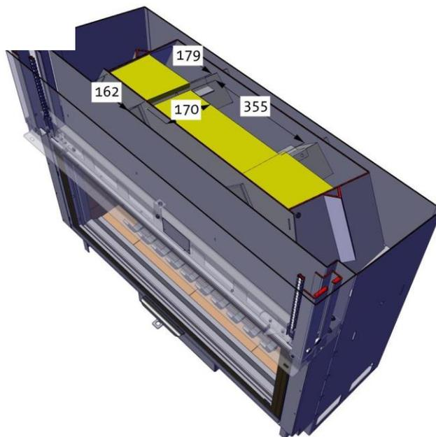
Défecteurs intermédiaires en 3 parties, Les latéraux reposent sur l'arrête supérieure de la tuyère et un support métallique sur le côté de l'avaloir. Le central repose sur des fers plats en partie haute des tuyères. Ces déflecteurs sont en contact avec la face avant de l'avaloir. Les déflecteurs latéraux sont trapézoïdaux, la petite largeur est à l'avant
